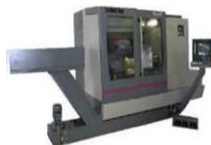
CNC Drehmaschine ST 10 Y Max. Ø165 mm Ymax = 100 mm
