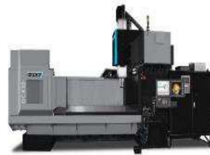
Hurco DCX32i mit MAX 5-Steuerung Xmax = 3.200mm Ymax = 2.100mm Zmax = 920mm
