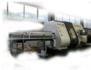
Nakamura WT-150 II Stangendurchlass max. 65 mm
