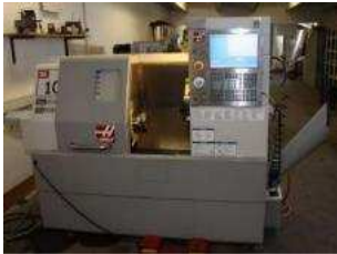
CNC Drehmaschine SL 10 Max. Ø165 mm
