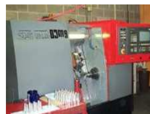
CNC Drehbank EMCO TURN 342 Max. \varnothing 250 \times 300 mm
