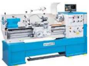
Universaldrehbank Max. Ø480 x 1200 mm Anzahl: 4 Stk.
