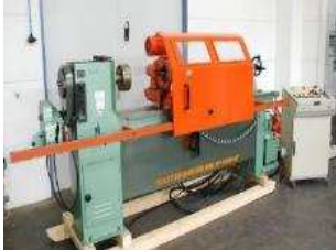
Kopierdrehmaschine Max. Ø150 x 1000 mm
