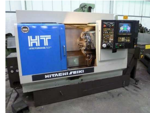
CNC Drehmaschine SL 10 Max. Ø165 mm
