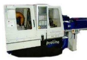
Maier ML 32C 8 angetriebenen Wkzg. u. 7 gesteuerten Achsen; Stangendurchlass max. 32 mm)
