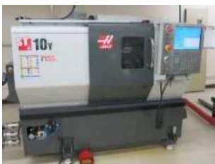
CNC Drehmaschine ST 10 Y Max. Ø165 mm Ymax = 100 mm
