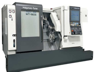
Nakamura WT-150 II Stangendurchlass max. 65 mm
