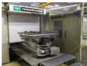
Tiefbohr-Maschine von Ø1 – Ø15 – 800 mm
