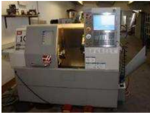
CNC Drehmaschine SL 10 Max. Ø165 mm
