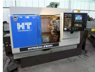
CNC Drehmaschine SL 10 Max. Ø165 mm
