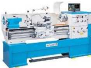
Universaldrehbank Max. Ø480 x 1200 mm Anzahl: 4 Stk.
