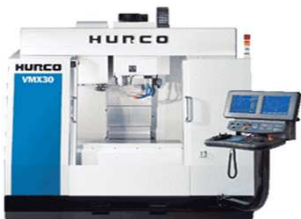
CNC Bearbeitungszentrum Hurco VMX 30 X-max: 1.625 mm Y-max: 825 mm Z-max: 760 mm
