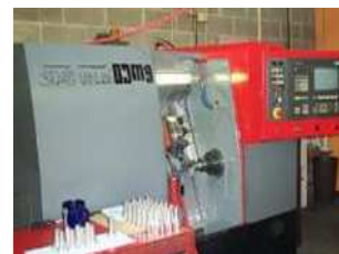
CNC Drehbank EMCO TURN 342 Max. Ø250 X 300 mm
