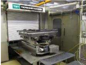
Tiefbohr-Maschine von \varnothing 1 – \varnothing 15 – 800 mm
