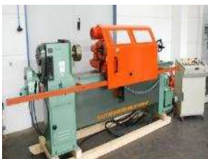
Kopierdrehmaschine Max. Ø150 x 1000 mm
