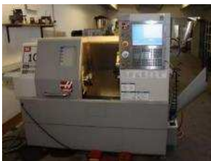
CNC Drehmaschine SL 10 Max. \varnothing 165 mm
