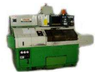
Mazak max. Ø125 mm Länge bis max. 200 mm
