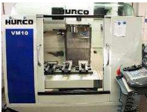
CNC Bearbeitungszentrum Hurco VM 10 X-max: 630 mm Y-max: 510 mm Z-max: 510 mm
