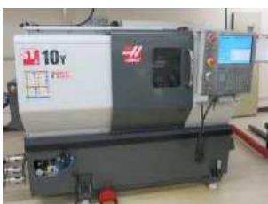
CNC Drehmaschine ST 10 Y Max. \varnothing 165 mm Ymax = 100 mm
